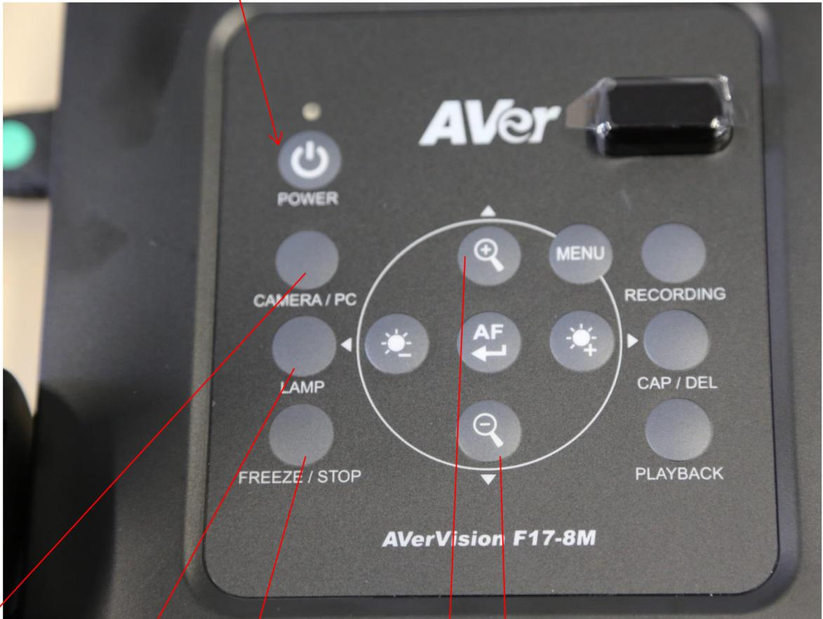
Umschalten zwischen Bild der Kamera und dem Bildschirm eines Laptops
