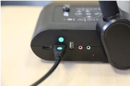
3. Verbinden Sie das HDMI-Kabel mit der entsprechenden Buchse neben der Whiteboard
